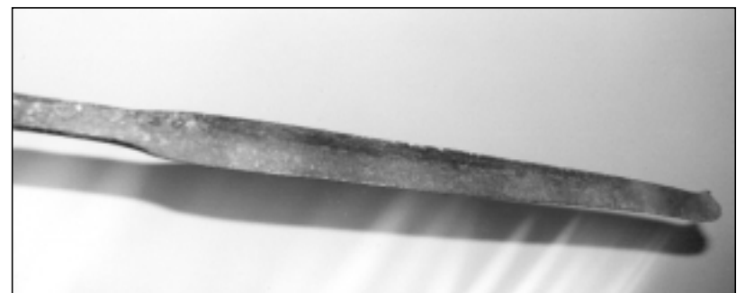
Attrezzo metallico usato a Battaglia di Campli per tagliare la neve pressata (diventata ghiaccio) conservata nelle apposite buche dette n’vire .
